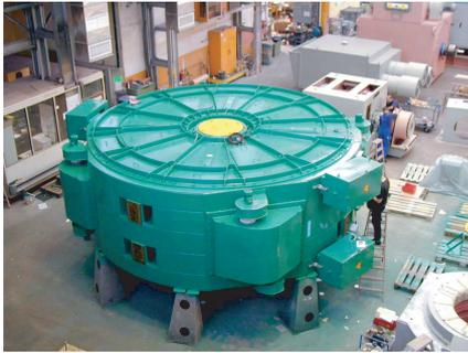
Getriebeloser Windkraftgenerator. Tausend dieser Generatoren erreichen bei starkem Wind fast die Leistung der nebenstehenden Turbogruppe.
